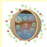
L'eau entrée dans le granulé provoque une surpression. Les éléments nutritifs sont envoyés dans la solution du sol.
