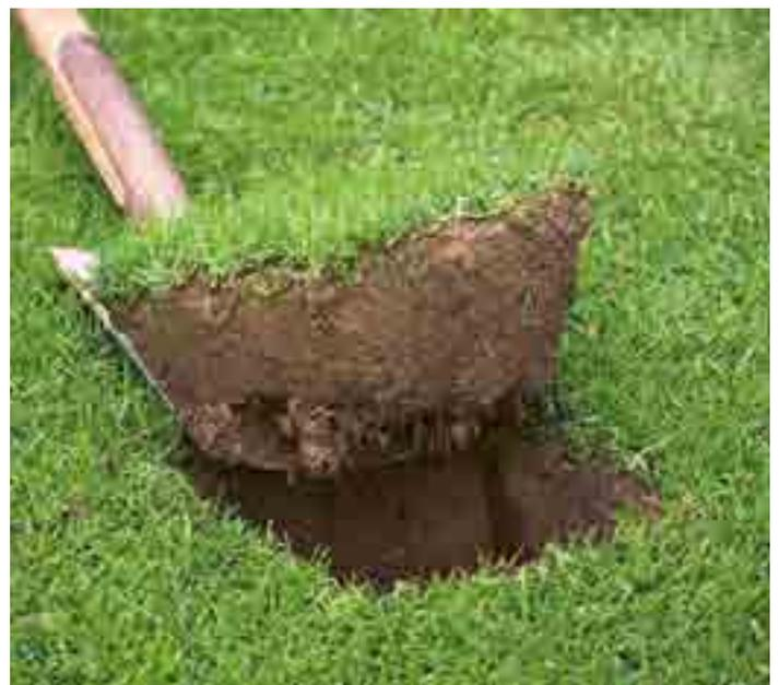
Mit einer Spatenprobe werden Boden- und Rasenqualität ermittelt – eine einfache Erfolgskontrolle zu den Pflegemassnahmen.
