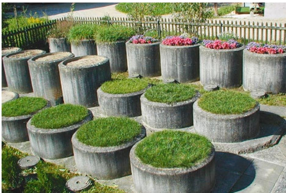
Lysimeteranlage mit verschiedenen Bewuchs- und Substrattypen
