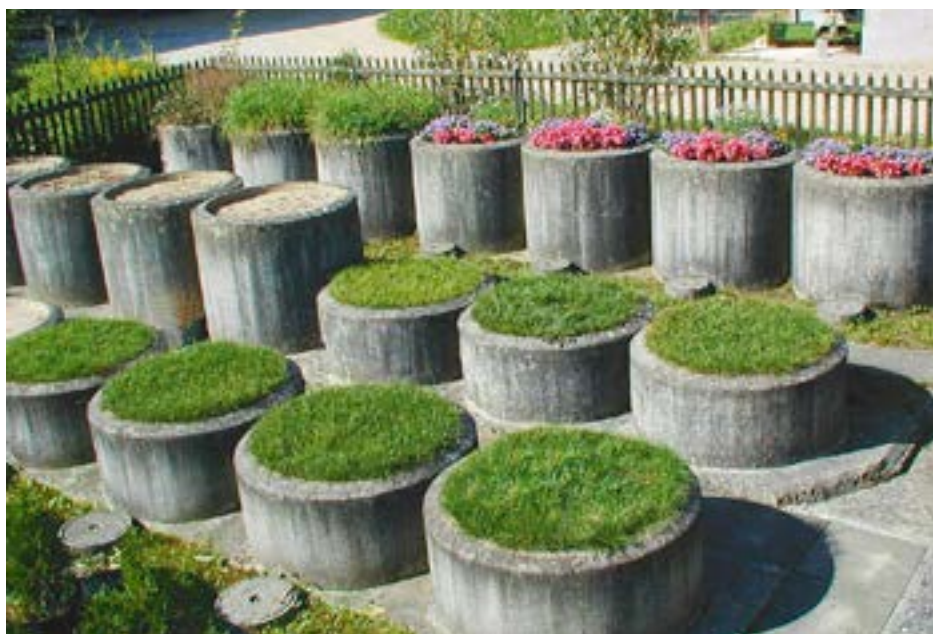
Lysimeteranlage mit verschiedenen Bewuchs- und Substrattypen
